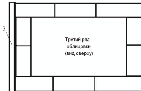
Рис. 27. Схема сборки третьего ряда облицовки
