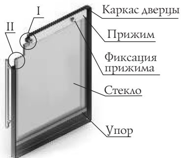
Рисунок 9. Ремонт светопрозрачного экрана дверцы модели «Люмина»
