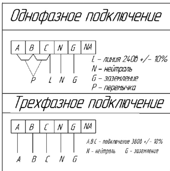
Рис. 4. Схемы подключения электрического котла к электросети.
