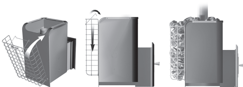
Рисунок- 10. Установка сетки-каменки на печь.
