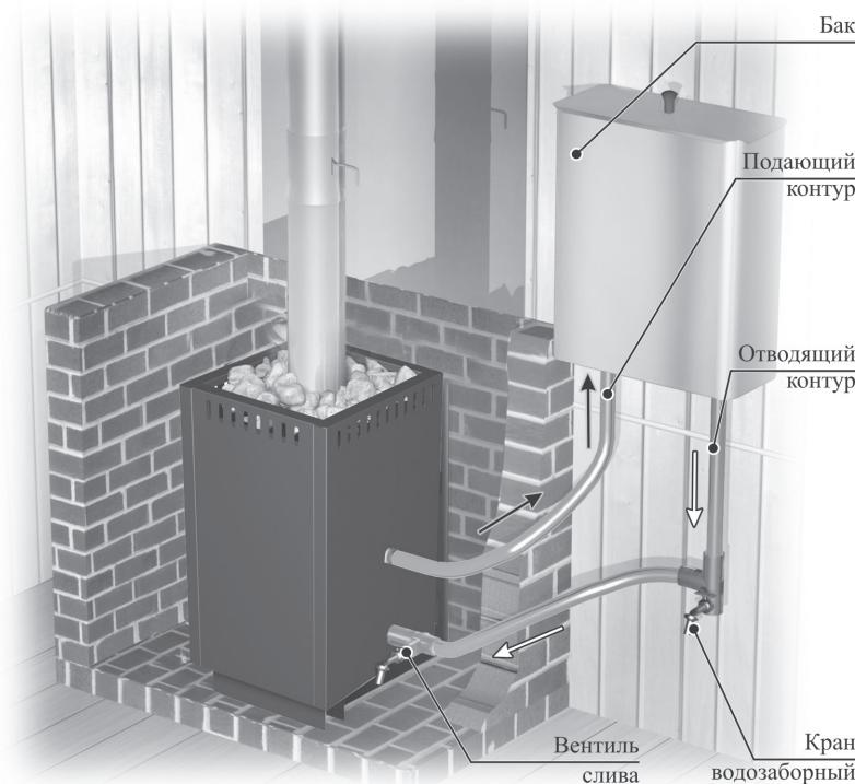
Уклон подающего и отводящего контура не менее 20° в направлении от бака к печи
