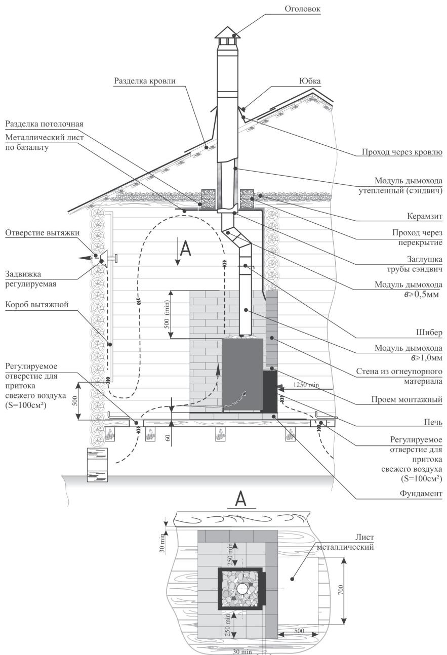
\* $\delta$  – соответствует толщине металла модуля дымохода
